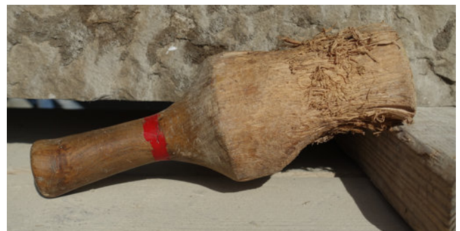
13 Stark abgearbeiteter Knüpfel aus einem Stück, der nicht wiederverwendet werden kann (Foto: Heiko Steinwand).
