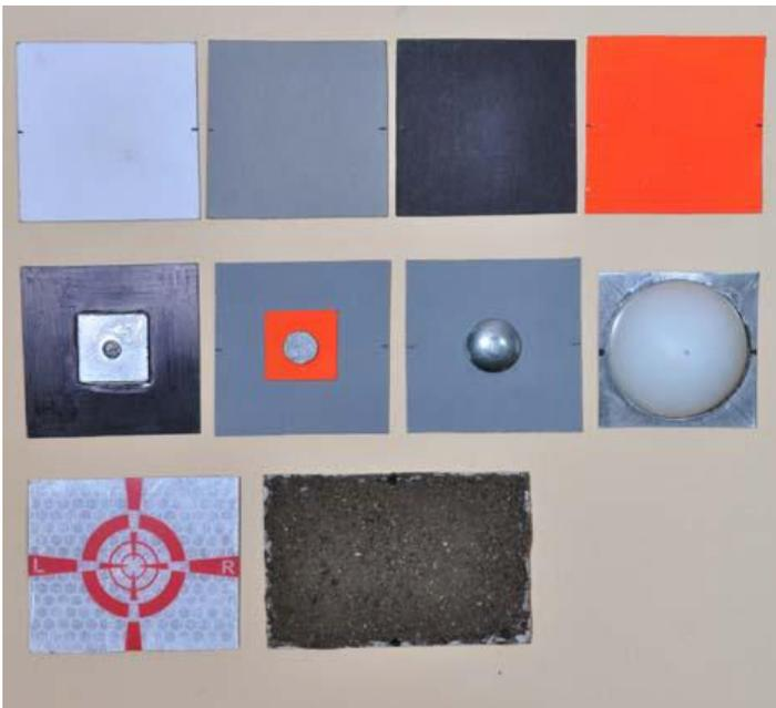
Abb. 11 Reflektoren für die „reflektorlose“ Messung (H. Lang).
