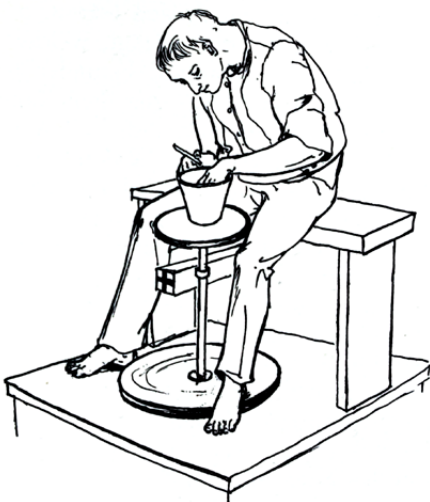
17 Abbildungsschema einer Drehscheibe mit Fußantrieb (Goebels 1985, 65).
