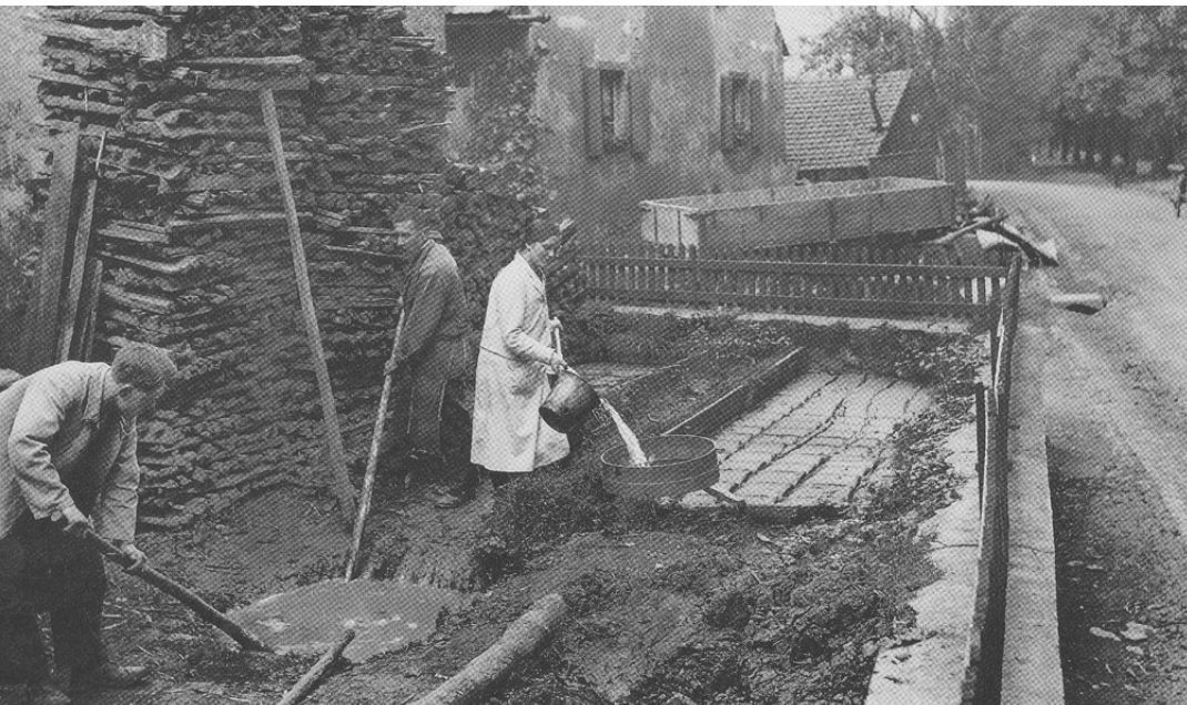
5 Der Hafnermeister Josef Maier, seine Tochter Emma und ein Gehilfe beim Schlämmen von Ton auf dem Grundstück hinter der Hafnerei Maier in Staufen. Im Hintergrund an der Hauswand ist Brennholz für den Brand gestapelt, rechts befindet sich das Schwämmebeet, in Quadrate eingeteilt (Fotografie Kuban, 1925. BLM Außenstelle Staufen, Sammlung Maier/Bregger, Inv. Nr. BA 2005/747).
