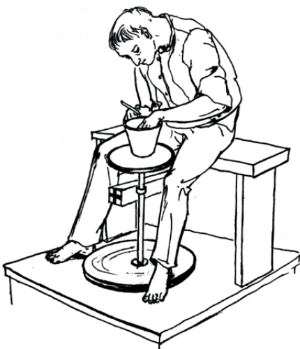
17 Abbildungsschema einer Drehscheibe mit Fußantrieb (Goebels 1985, 65).
